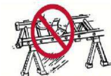
شکل ۳۳- استفاده از نردبان به عنوان جایگاه کار ممنوع
