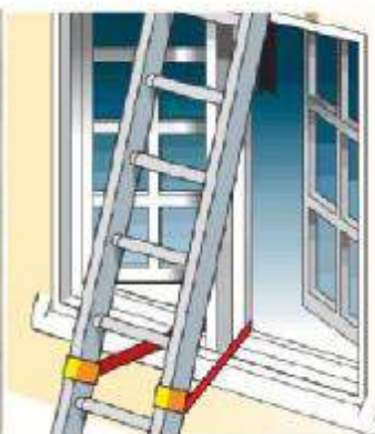
شکل ۸- نحوه تکیه‌گاه فوقانی نردبان یک طرفه
