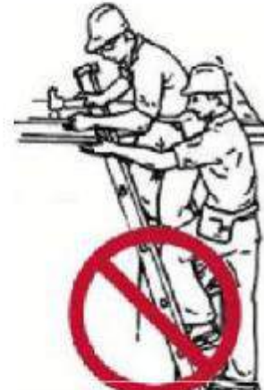
شکل ۱۲- استقرار همزمان دو نفر ممنوع
