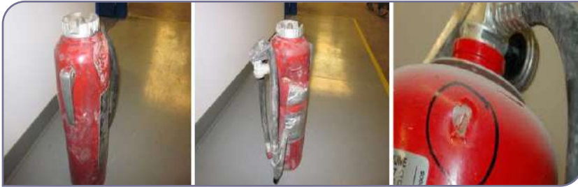
شکل ۱-۶. به روز دفرمگی در اثر ضربه به خاموش کننده
